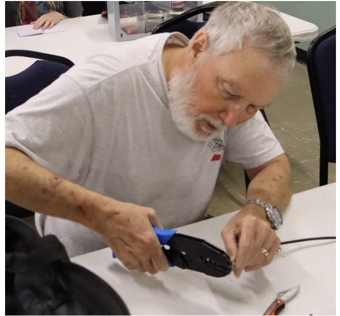
Tom KFØRWS applying a crimp on BNC center pin
